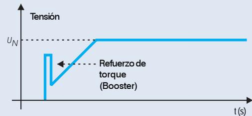
Permite un pulso inicial de tensión que aplicado al motor proporciona un refuerzo del par (torque) en el arranque, necesario para cargas con elevado atrito estático.
