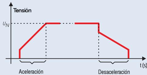
Permite la aceleración y/o desaceleración suaves. En la aceleración ajustase también la tensión inicial. En la aceleración ajustase el escalón inicial de tensión. La aceleración suave evitará el "Golpe de Ariete" en sistemas de bombeo.
