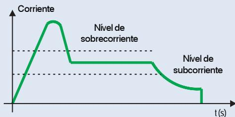
Permite ajustar los límites de subcorriente y sobrecorriente para la completa protección del motor. La protección de subcorriente es ideal para aplicaciones en bombas a fin de evitar el funcionamiento a vacío. Solamente esta activa cuando la Soft-Starter esta en tensión plena.
